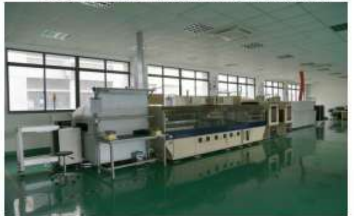
Участок СМД монтажа
